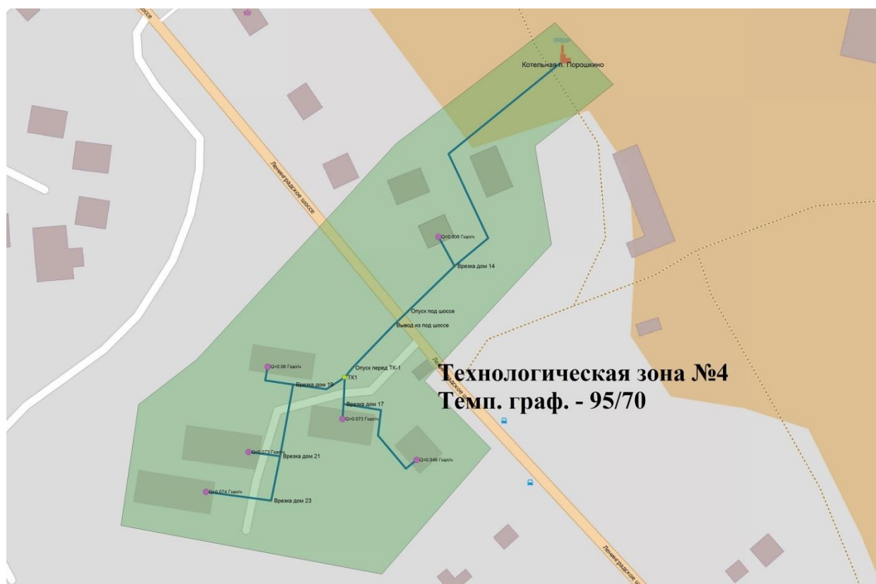
Рисунок 7 - Зона действия котельной в д. Порошкино
