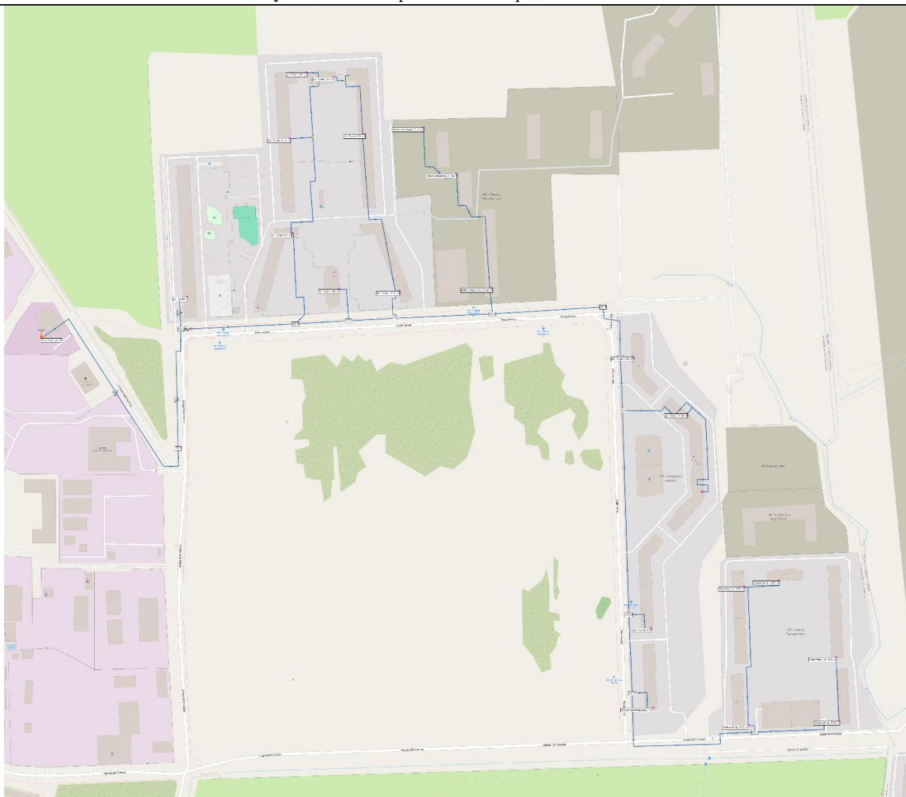
Рисунок 13. Схема магистральных тепловых сетей от котельной уч. 37 (зона действия №6), г. Бугры
