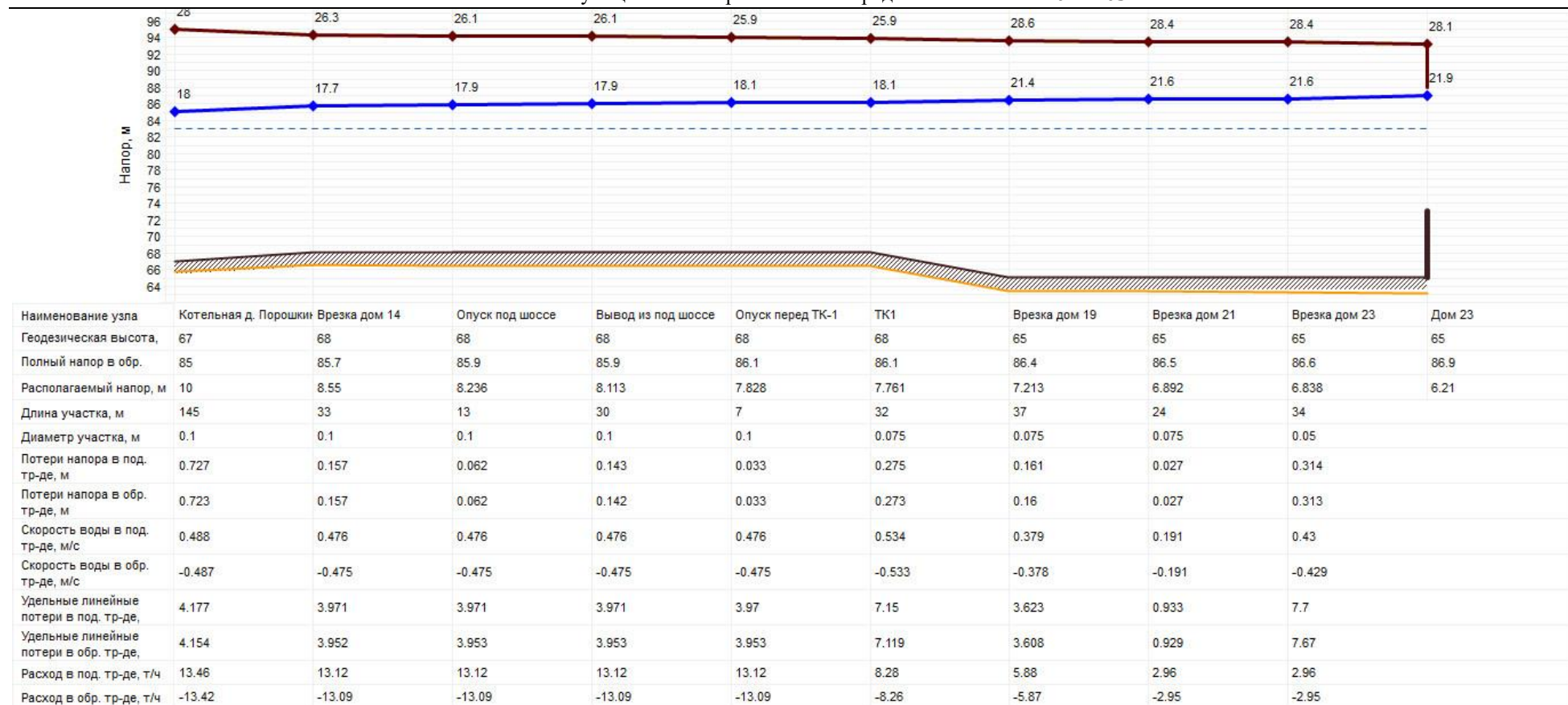
Рисунок 23. Пьезометрический график зоны действия №4, д. Порошкино, от котельной №30 до д. 23
