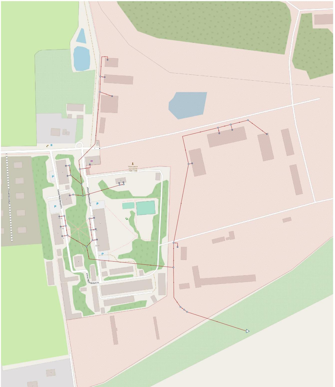
**Рисунок 30 Существующая схема водоотведения хозяйственно-бытовой канализации д. Капитолово (зона ВО №5)**
