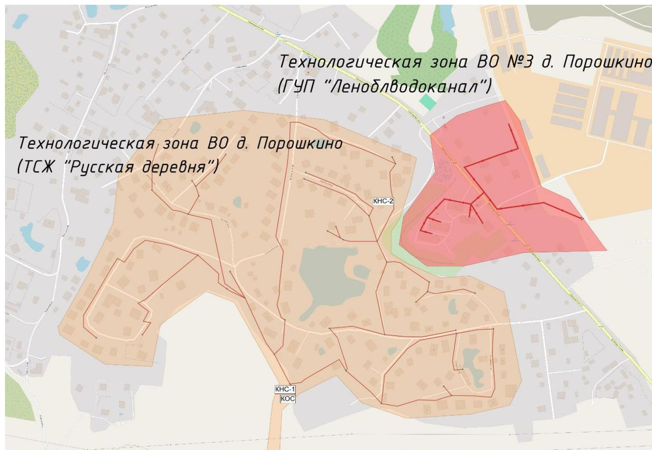
**Рисунок 28** Существующая схема водоотведения хозяйственно-бытовой канализации д. Порошкино
