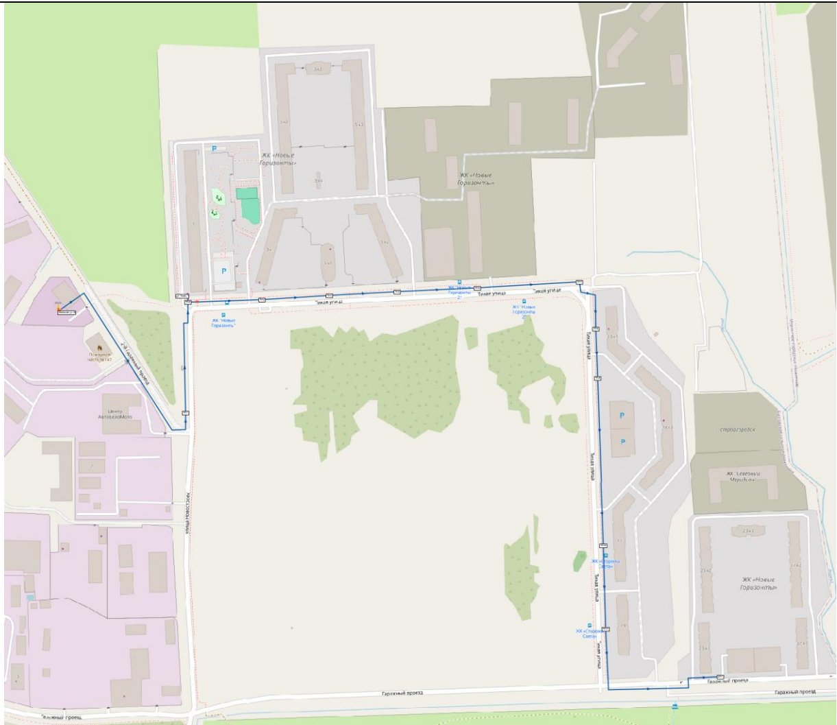
Рисунок 12. Схема магистральных тепловых сетей от котельной уч. 37 (зона действия №6), г. Бугры
