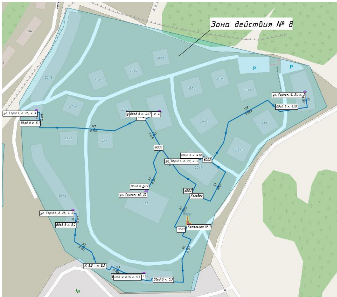
Рисунок 33. Зона действия №8 от котельной №1 д. Мистолово
