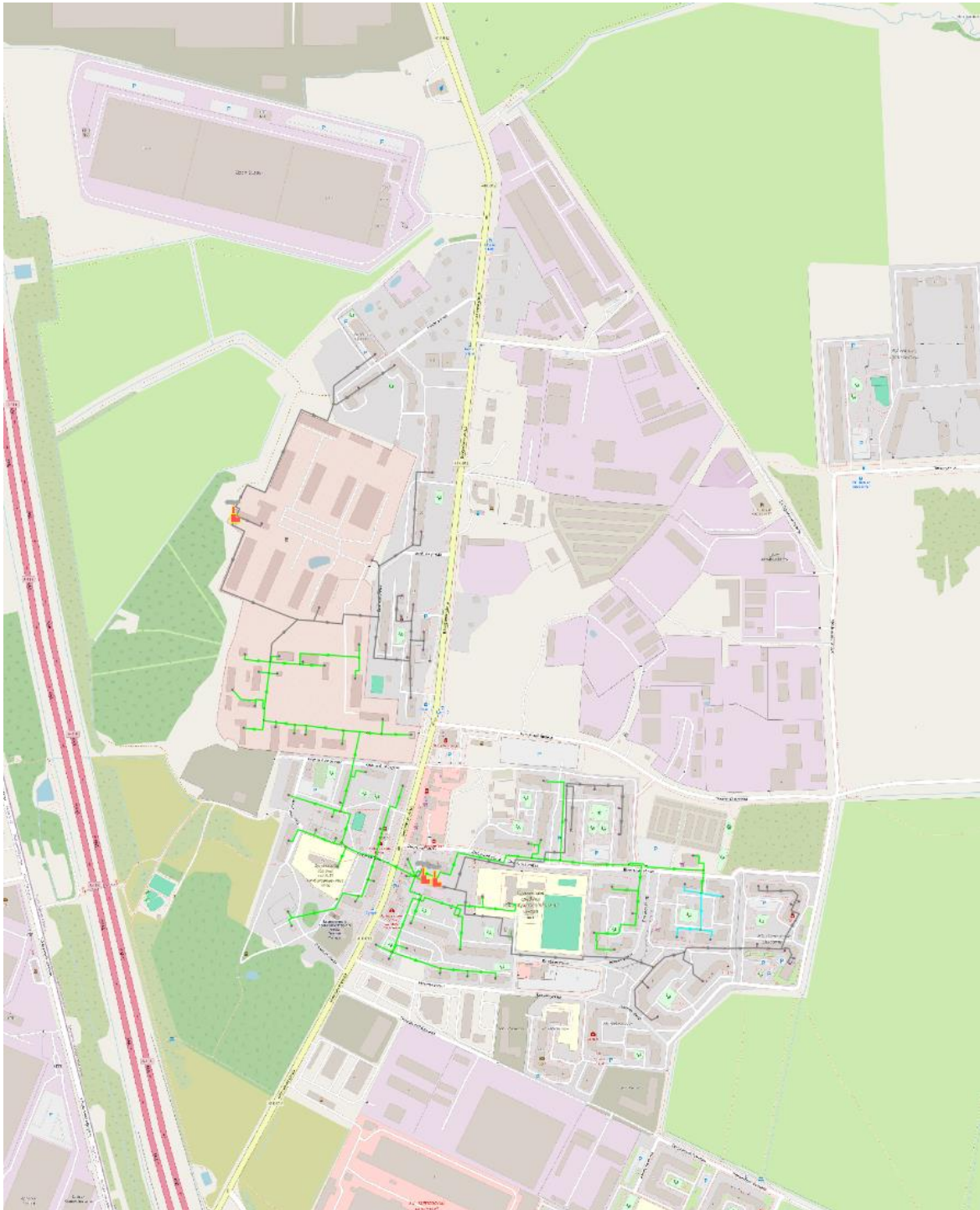
Рисунок 50 Схема тепловых сетей котельной №29 в раскраске по располагаемому напору при безаварийной ситуации
