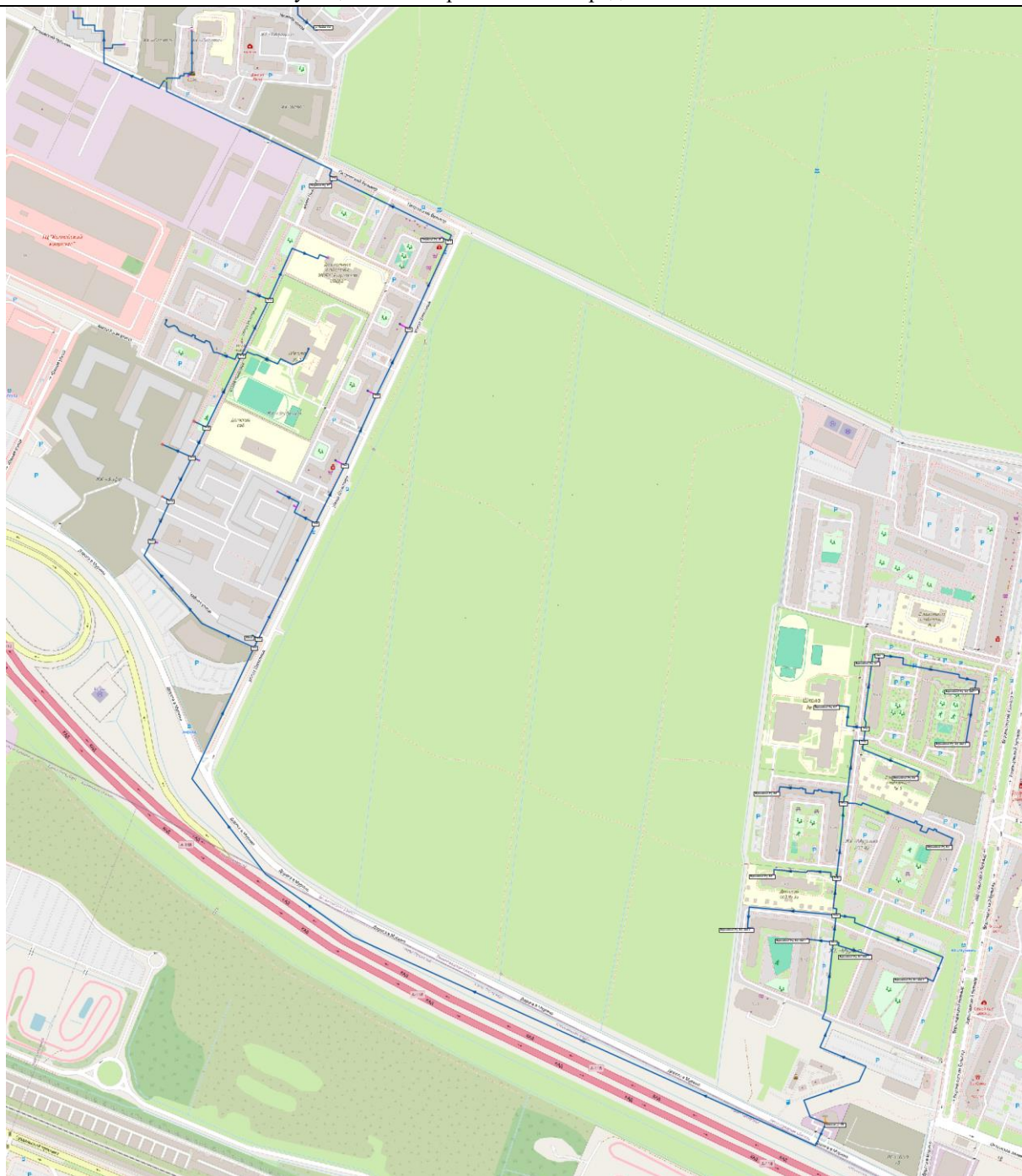
Рисунок 11. Схема тепловых сетей от котельной уч. 978 (зона действия №5), г. Бугры
