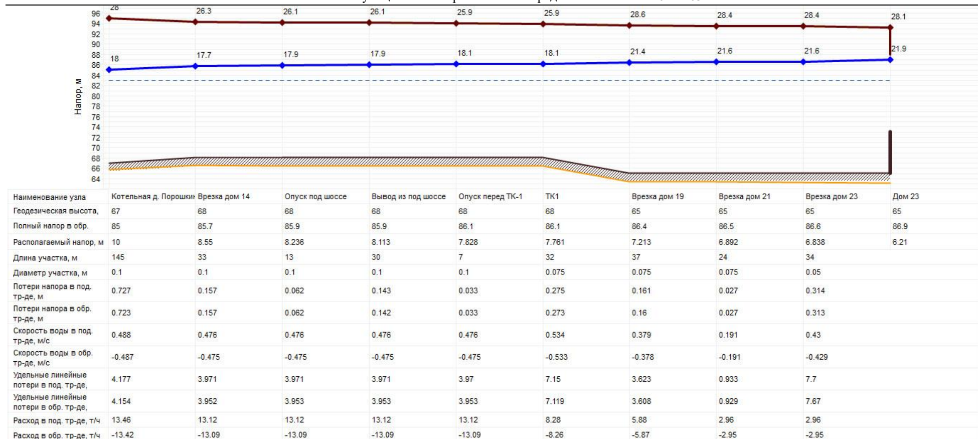
Рисунок 22. Пьезометрический график зоны действия №4, д. Порошкино, от котельной №30 до д. 23
