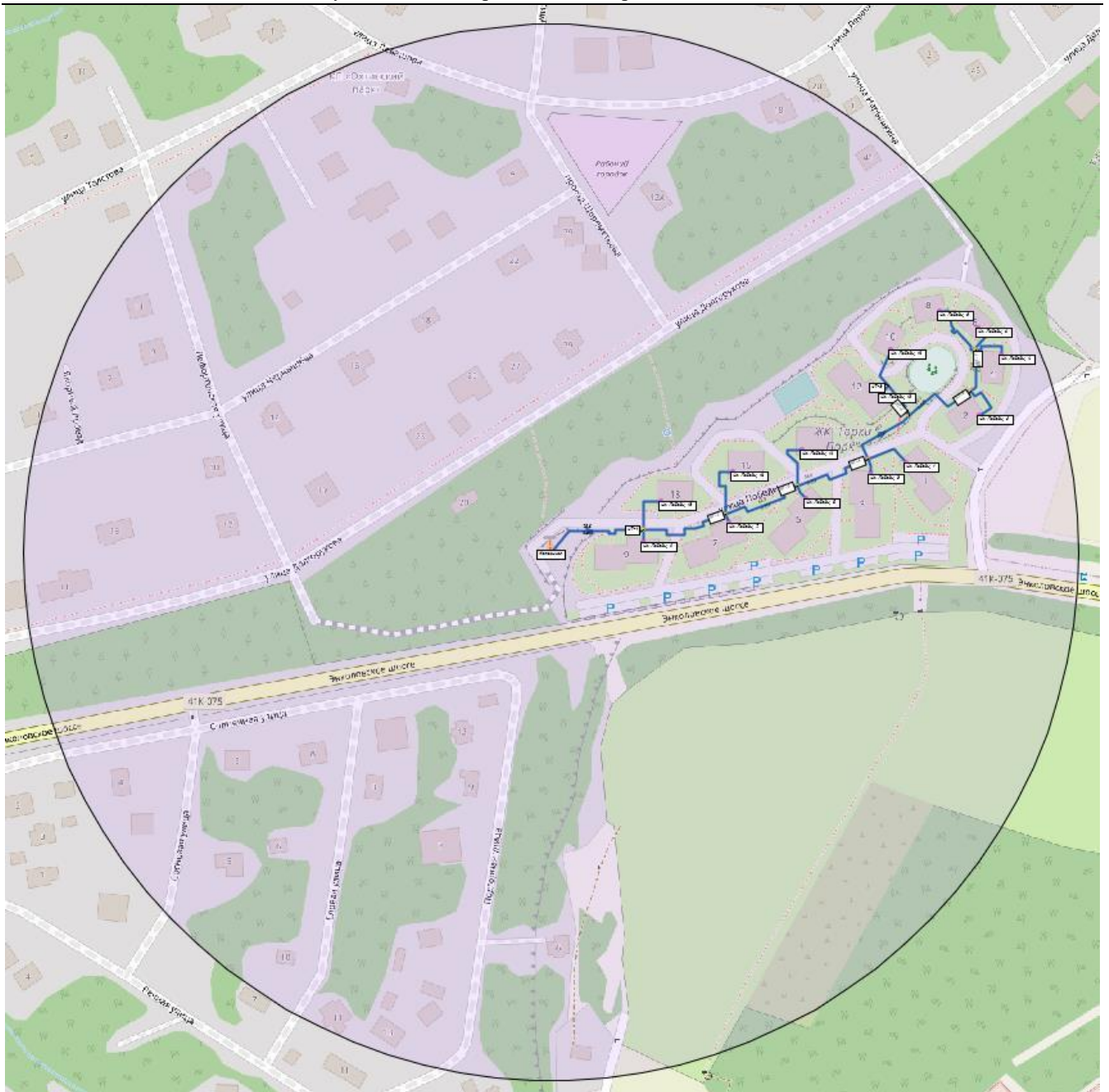
Рисунок 60. Радиус эффективного теплоснабжения котельной д. Энколово (зона действия №7)
