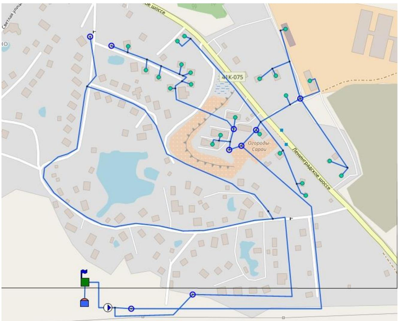
**Рисунок 6 Схема водоснабжения дер. Порошкино (технологическая зона ВС №3)**
