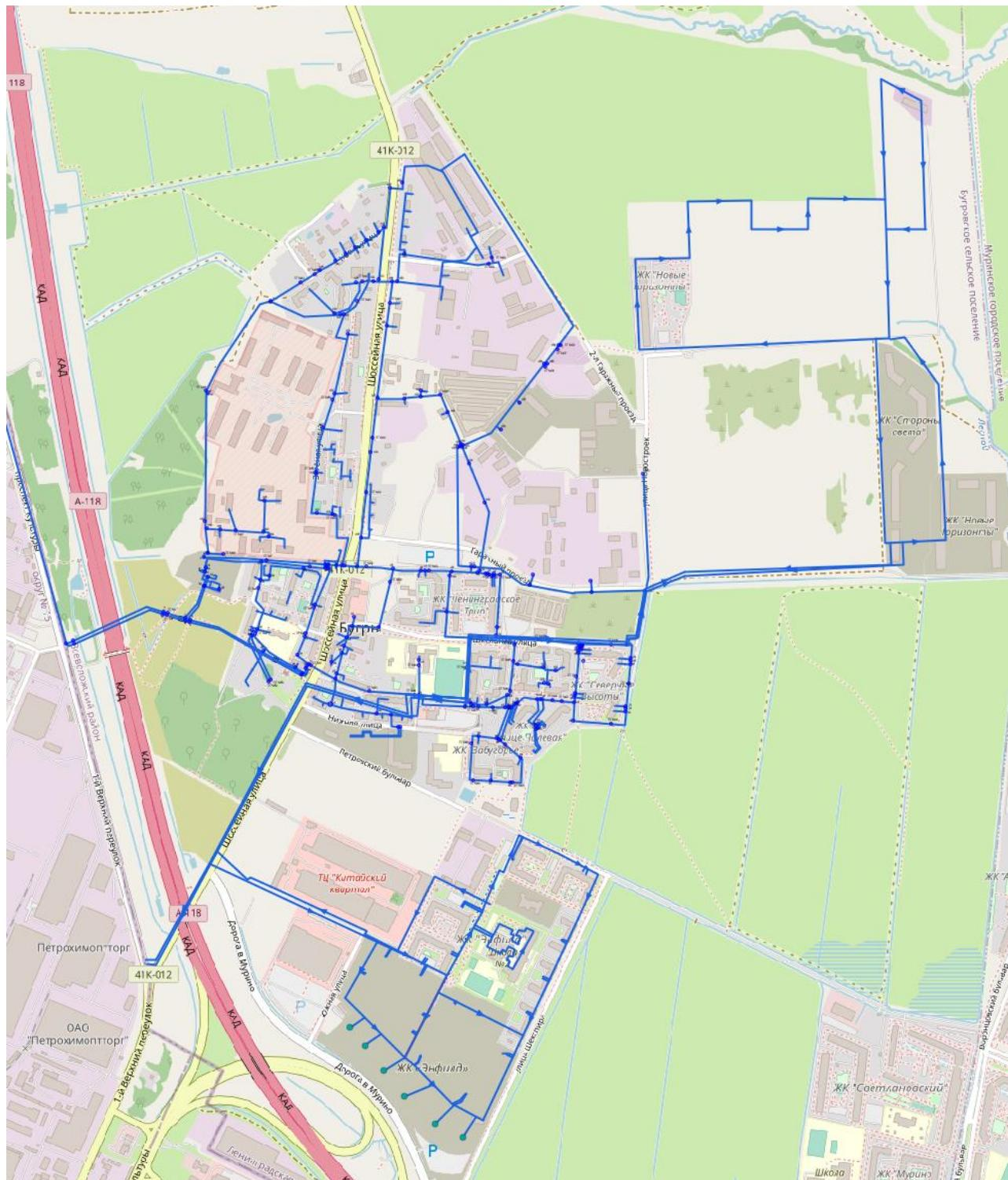
Рисунок 4 Схема водоснабжения пос. Бугры (технологическая зона ВС №1)
