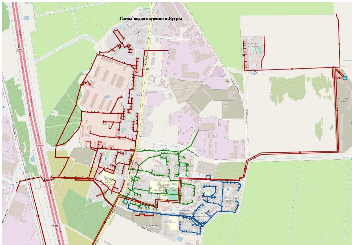
Рисунок 24 Существующая схема водоотведения хозяйственно-бытовой канализации п. Бугры (зона ВО №1)
