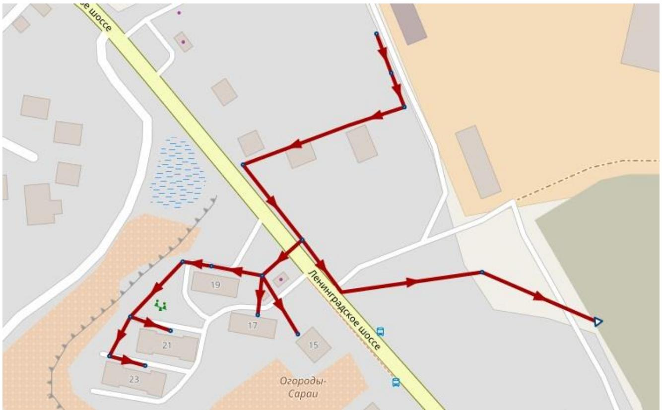
**Рисунок 28 Существующая схема водоотведения хозяйственно-бытовой канализации д. Порошкино (зона ВО №3)**
