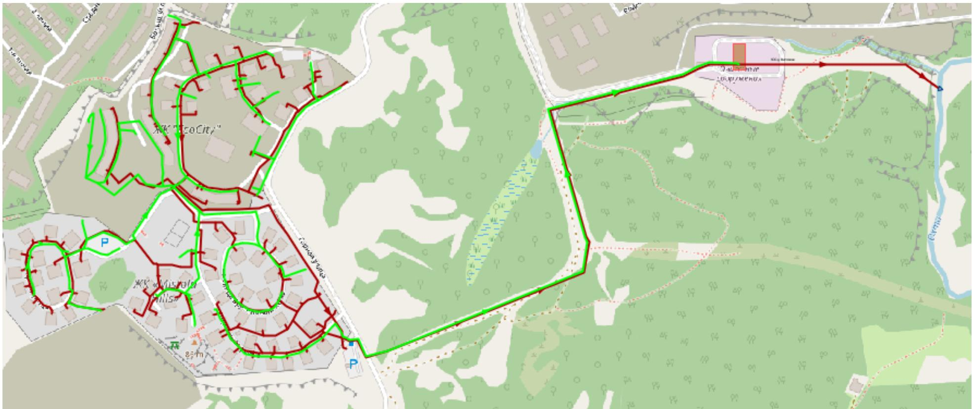
**Рисунок 29 Существующая схема водоотведения хозяйственно-бытовой и ливневой канализации д. Мистолово**
