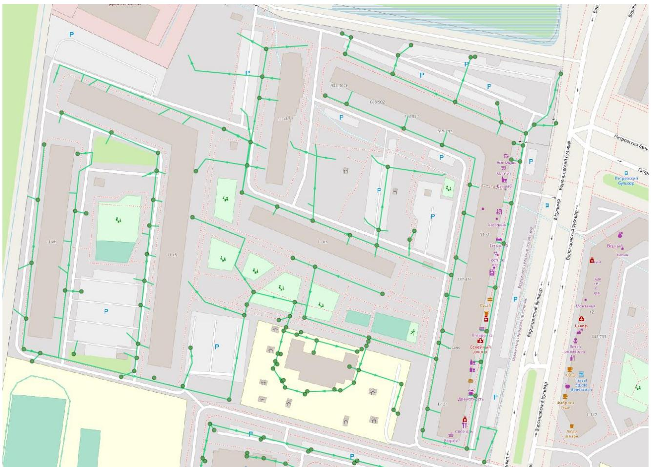
**Рисунок 31 Существующая схема дождевого коллектора
