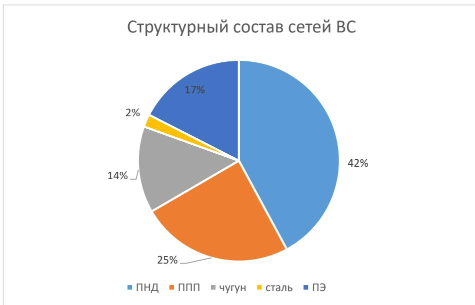
**Рисунок 15 Структурный состав сетей водоснабжения
