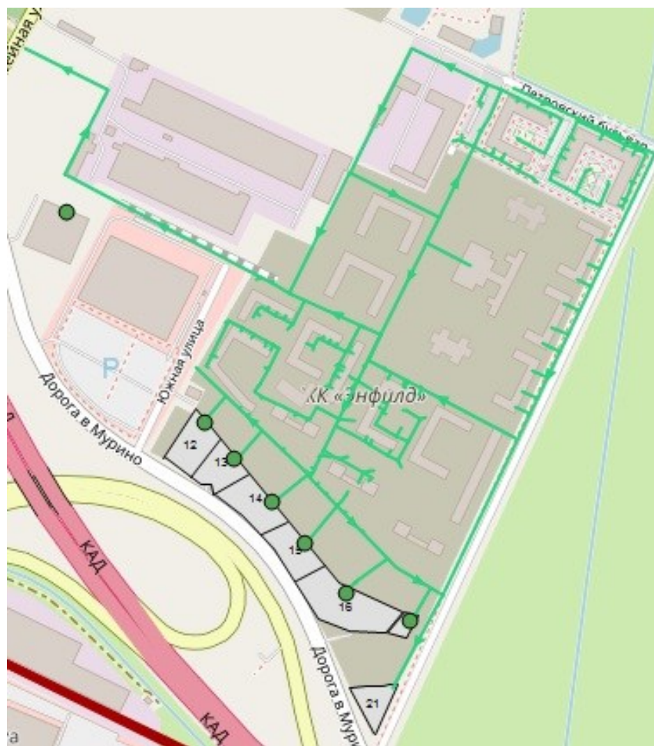
Рисунок 32 Существующая схема ливневого коллектора ЖК «Энфилд» от застройщиков ООО «Арсенал Групп», АО «Арсенал 2» (зона ВО №1.2)
