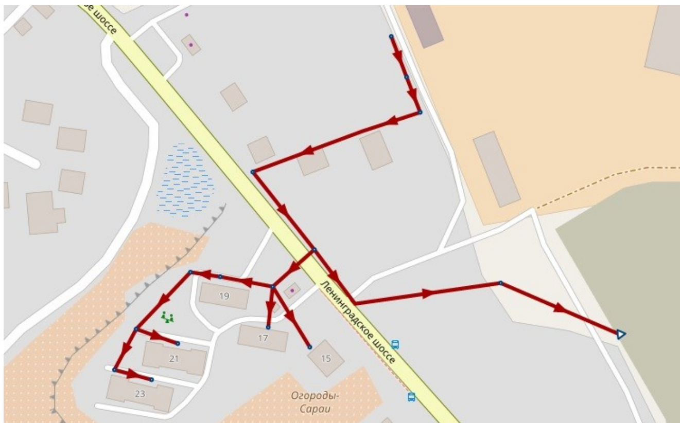
Рисунок 29 Существующая схема водоотведения хозяйственно-бытовой канализации д. Порошкино (зона ВО №3)
