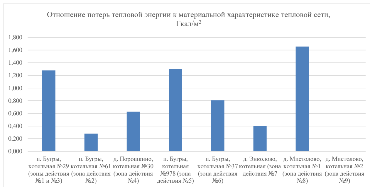
Рисунок 24. Отношение величины технологических потерь тепловой энергии, теплоносителя к материальной характеристике тепловой сети за 2020 год
