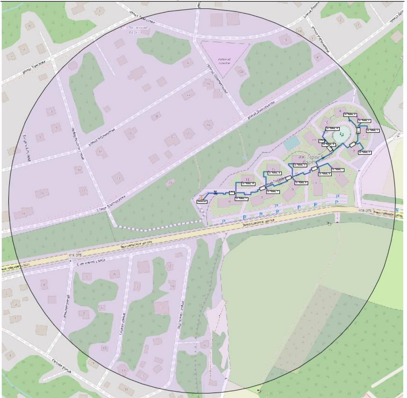
**Рисунок 15. Радиус эффективного теплоснабжения котельной д. Энколово (зона действия №7)**
